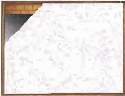
Ansicht: Backsteinmauerwerk mit Isolation eingebaut im Prüfstand 3/6
